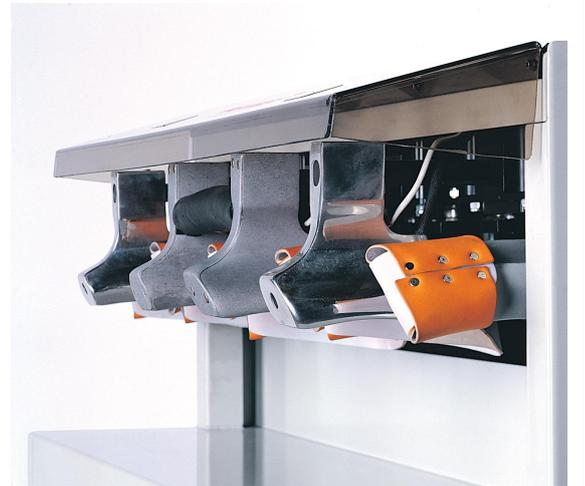
Maquina electroneumática compuesta de cuatro conjuntos horizontales para el conformado de los zapatos, con almohadillas fijas de presión regulable. Esta maquina consta de dos brazos con calor y dos con frío efectuando por esta razón una perfecta fijación de hueco.
