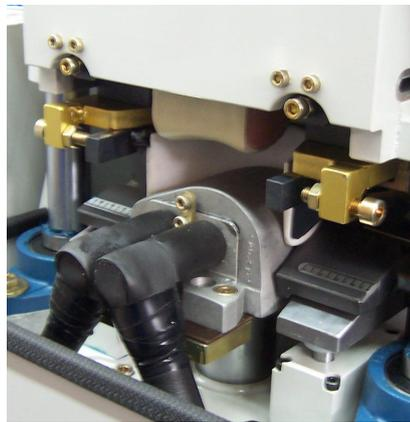
Sistema de cambio rápido de moldes y teflones.
