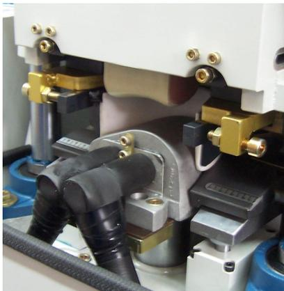
Sistema de cambio rápido de moldes y teflones.
